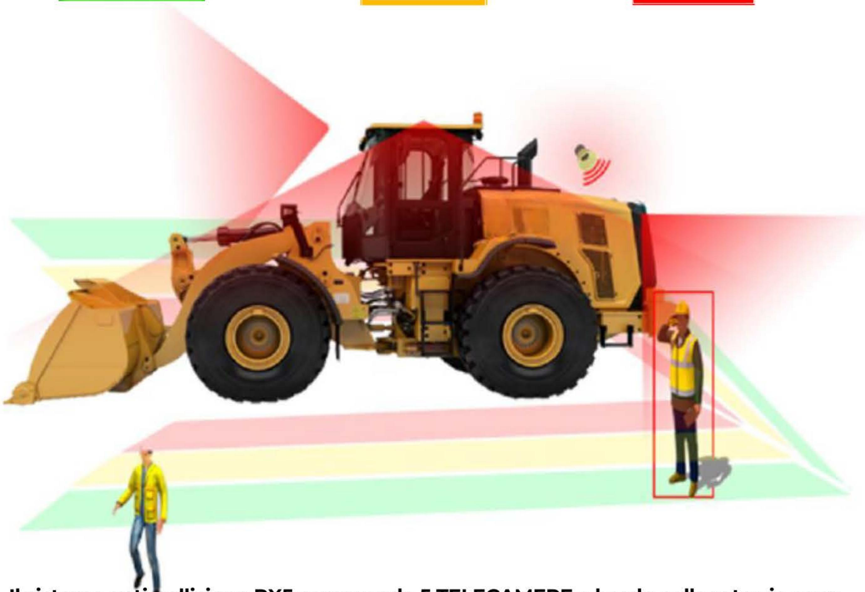
**Il sistema anti-collisione RX5 comprende 5 TELECAMERE a bordo collegate via cavo**
