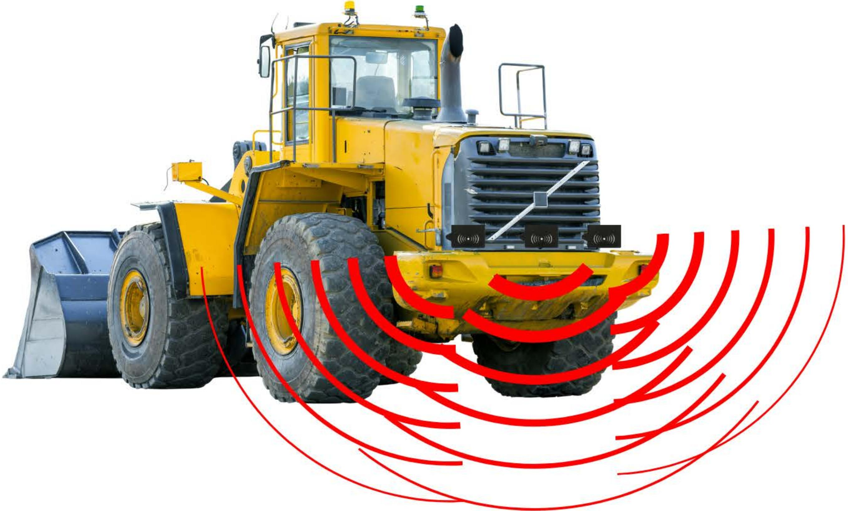
**RADAR X è composto da 3 sensori di prossimità installati sul retro della macchina operatrice consentono di rilevare in tempo reale ostacoli o persone presenti nell'area posteriore, in un raggio da 0 a 3 metri.**
