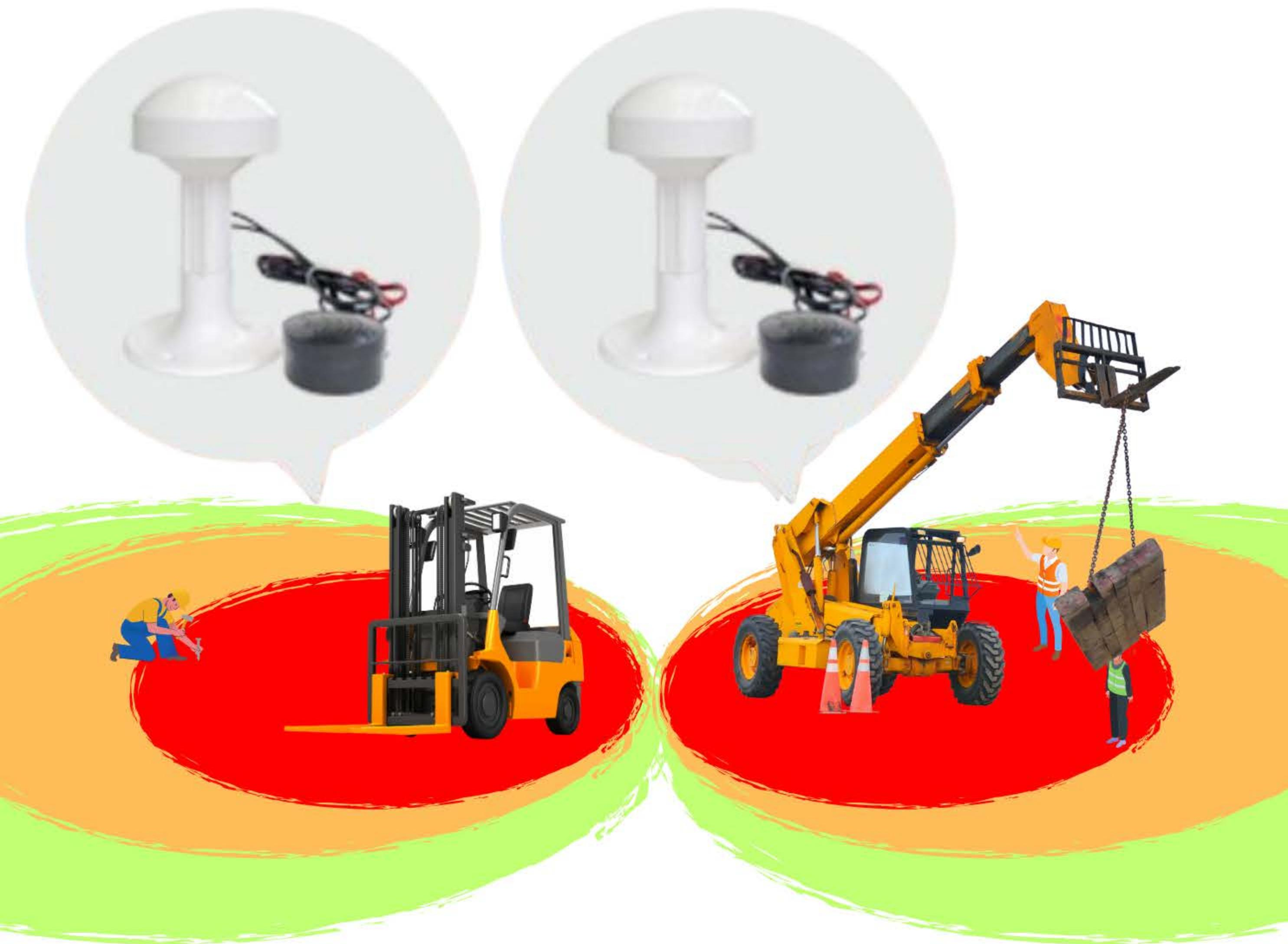
**Il sistema ANTI-COLLISION KIT comprende un sensore di riconoscimento veicolo ad antenna, un'interfaccia di regolazione da 1 a 40 mt e un segnale acustico incrementale.**
